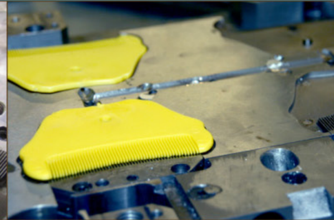
...lusekammen er ferdig støpt og klar til bruk.
