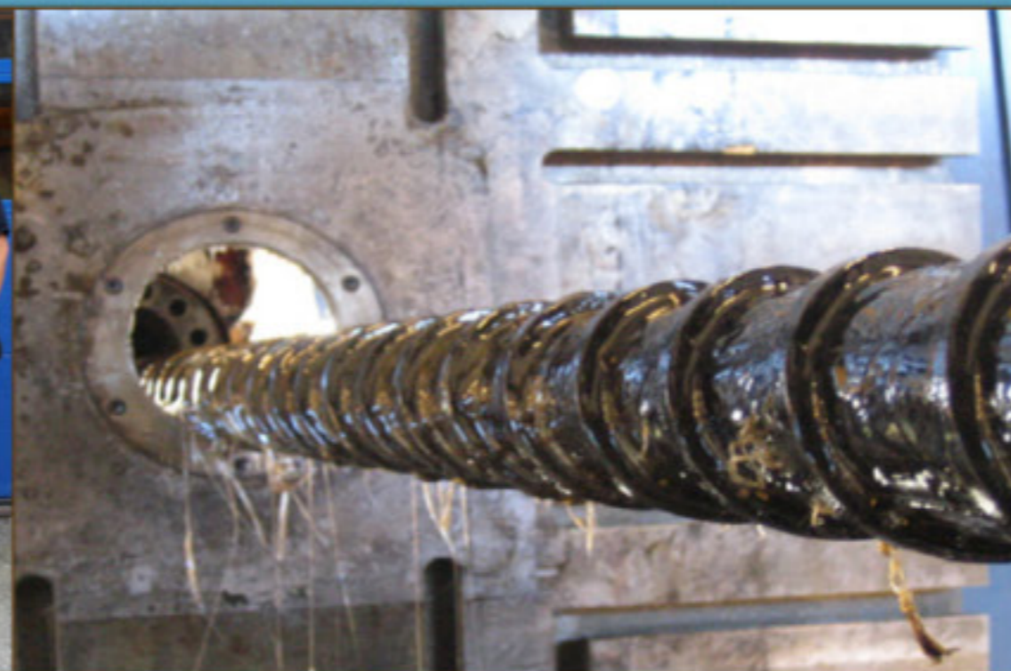
Store verktøy: Opptrekksskrue til 520 tonner.
